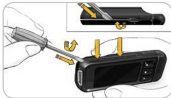
Um den Akku zur ordnungsgemäßen Entsorgung zu entfernen, müssen Sie das obere und untere Teil des Gehäuses mit Gewalt öffnen.
