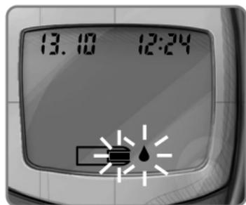
Das Messgerät schaltet sich ein. Sobald das Messgerät für die Messung bereit ist, wird das Bild eines Sensors mit einem blinkenden Blutstropfen angezeigt.
