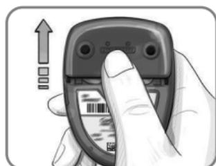
1. Vor dem Wechseln der Batterien das Messgerät ausschalten.
