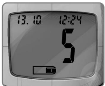
Daraufhin beginnt das Herabzählen von 5 Sekunden, woraufhin das Ergebnis der Kontrolllösungsmessung angezeigt wird.
